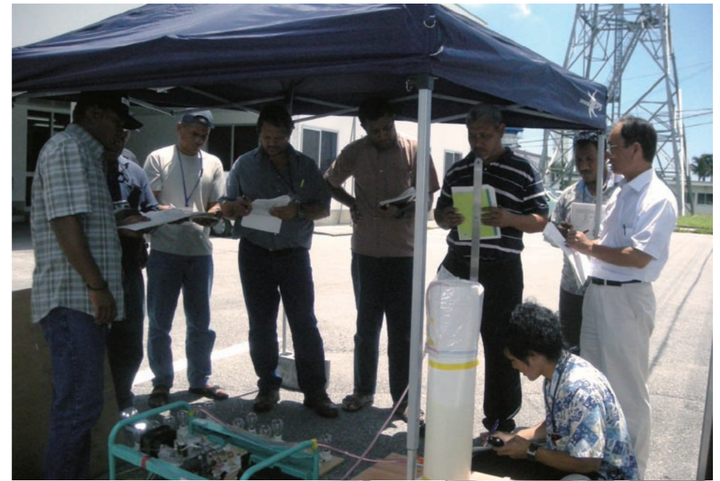
小型のディーゼル発電機を使って燃料消費率を計測
